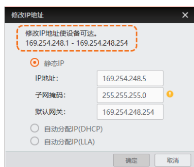
图 6-7 修改 IP 地址
