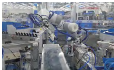
汽车接头密封圈安装
