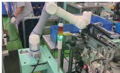
汽车油管接头组装
