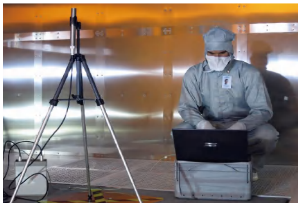
洁净室的磁场测量
