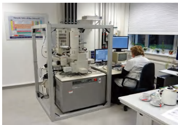
主动磁力补偿系统，线圈的独立框架
