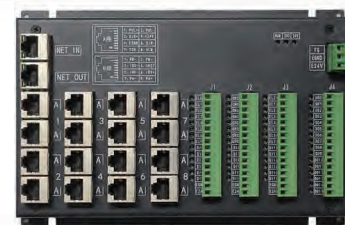
网口型运动控制卡: 12/16轴运动控制卡NMC5120/5160
