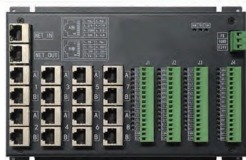
网口型运动控制卡: 6/8轴运动控制卡NMC5600R/5800(R)
