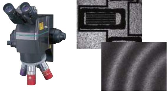
可視域から赤外域まで幅広い波長に対応する弊社製 M Plan Apo NIR シリーズを用いた光学系は生産・研究現場で多くのソリューションを提供しています。光源に赤外光を用い、可視光では不可能な非破壊検査が可能です。
