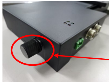
SBIS系列自动平台本体上带有JOG旋钮控制器，可以简单地进行手动操作。
