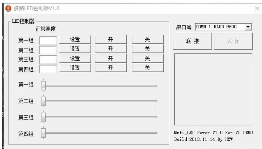
1、正常亮度：第1-4组分别对应光源CH1-CH4通道，通过滑块可以设定控制器输出控制光源亮度，亮度可0-255设定。
