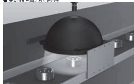
圆顶光源：DL-250SW的使用示意图
