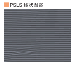
而线状图案光源，可把凹凸部分以曲线形式提取并实现成像。
