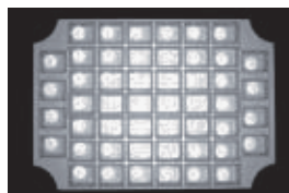
照射光集中在中央，难以进行稳定的检测。
