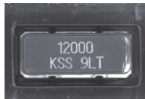
可抑制表面反射，使印字成像。
