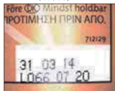
照射光集中在中央，难以进行稳定的检测。
