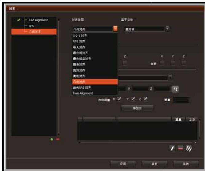
当有很多的几何形状的阻碍不同方向，使用此对齐。例如，表面点方挡住了 Z 方向并且圆阻碍了 X，Y 方向。
