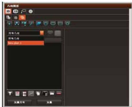
用户可以从图标
