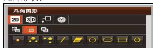
用户单击他想要测量几何图形。这种几何结构将在“测量”窗口被添加。在“测量”浮动窗口中，从列表中选择一个几何特征后，它的三维尺寸可以通过单击“测量”来获得。还有一个“测量所有”按钮，这将测量所有树中的几何特征，无论其是否已经被选中。
