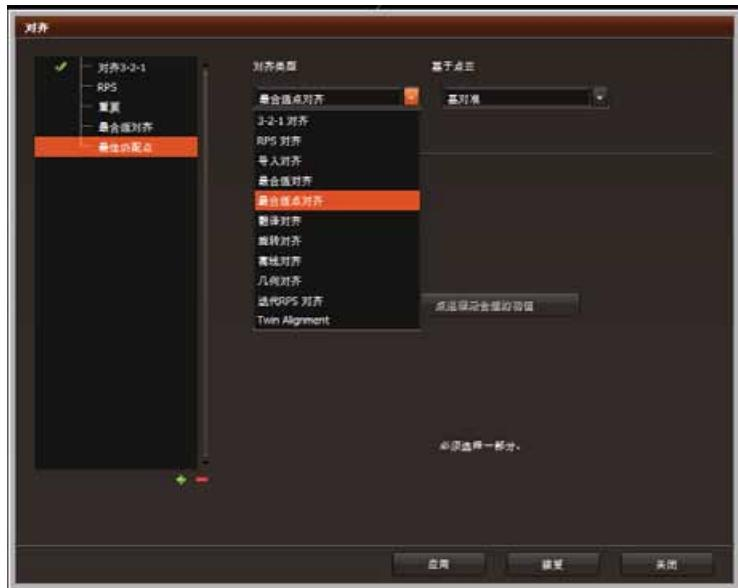
这个对齐用于点云（光学传感器）。单击“开始处理最佳匹配点”图标开始处理。**M3** 将显示一个窗口，用户可以在其中选择 **M3** 用来对齐的点。
