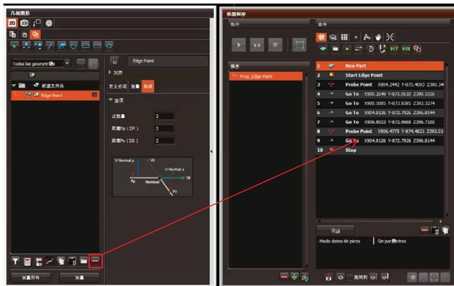
要显示的轨迹，在“机器程序”窗口中使用“显示 STL 点”图标。
