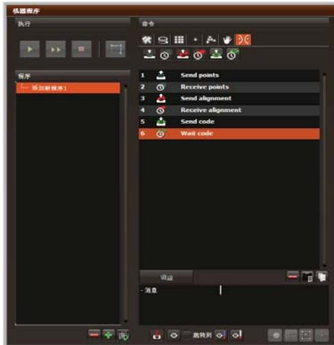
发送/接收对齐 Send/Receive alignment: 主机做出调整（例如：几何校正）。主机发送这个对齐。副机接收该对齐并应用它继续该程序。
