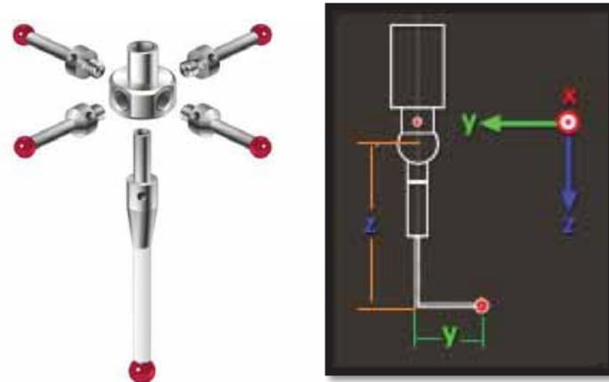
在这种情况下，平面的方向是：Z 和 Y（探头在该图的坐标系统的方向）。
