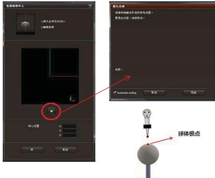
探头必须是 A0 B0 并且用户必须接接触球体极点。然后，M3 将获得更多的四点来计算球体中心的地位。
