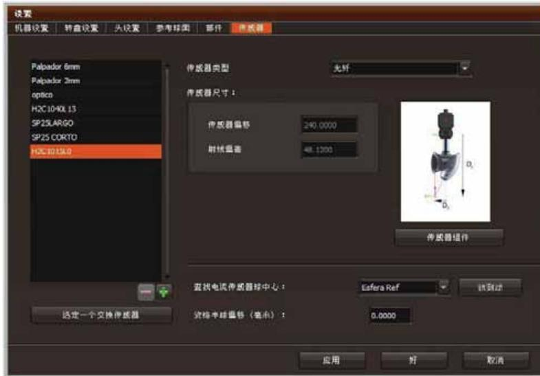
当 **M3** 连接时，“设置/机器设置”中显示此窗口。传感器会自动显示 OptiScan 1040L 的空间维度。
