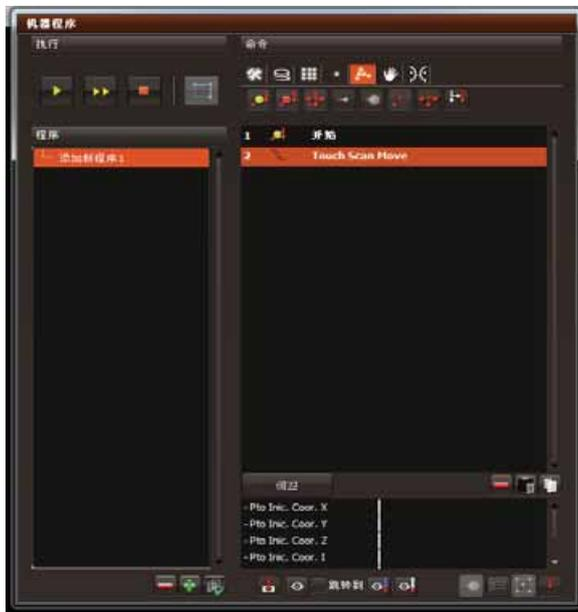
在“触摸扫描移动 *Touch Scan Move*”命令的选项中，引入了起点及其向量（初始化 Pt Coord. X，初始化 Pt Coord. Y，初始化 Pt Coord Z；初始化 Pt Coord I，初始化 Pt Coord J，初始化 Pt Coord K）以及工作平面一般向量（平面 Plane Coord I，平面 Plane Coord J，平面 Plane Coord K）。
