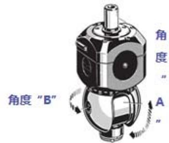
由于方向轴的原因，用户可以使用偏移量来校准一些方向。在“传感器”窗口（设置/机器设置/传感器）可输入偏移量。
