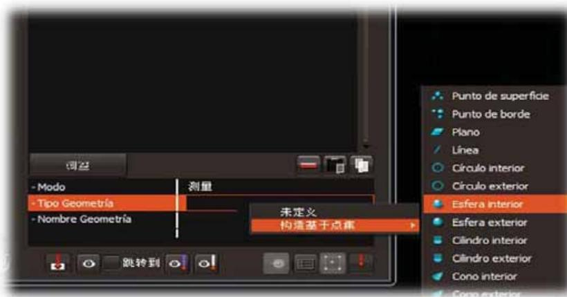
通过选择“开始触摸扫描 *Start TouchScan*”命令，用户可以获取点(探测点)来定义我们几何形状。要做到这一点，用户单击“获取探测点”的图标
