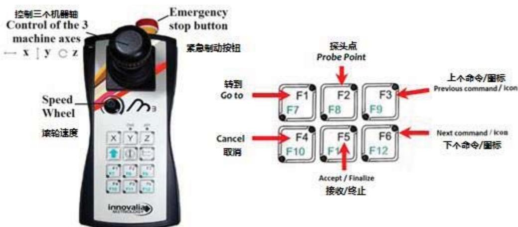
使用 Deva 操纵杆，用户可以控制操纵杆的软件。要做到这一点，用户必须点击下图的标记图标：
