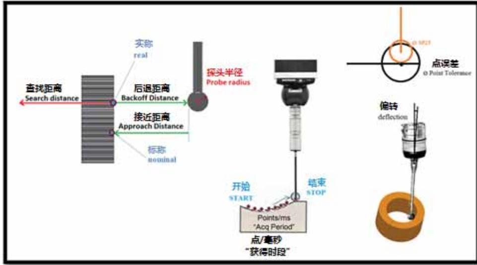
SP25 具有与触摸传感器相同的扫描设置：触摸和回退的速度，扫描方式和后退距离，以及搜索距离。但是，在该传感器中，用户必须配置多个参数。当触摸扫描传感器被 **M3** 激活，这些参数显示在下面“设置/扫描设置”的菜单中。
