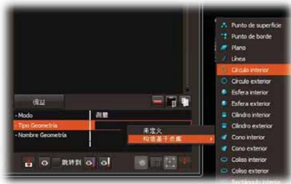
为了保存定义几何的点（探测点），用户须选择“启动触摸扫描”命令，必须单击“获取探测点”图标
