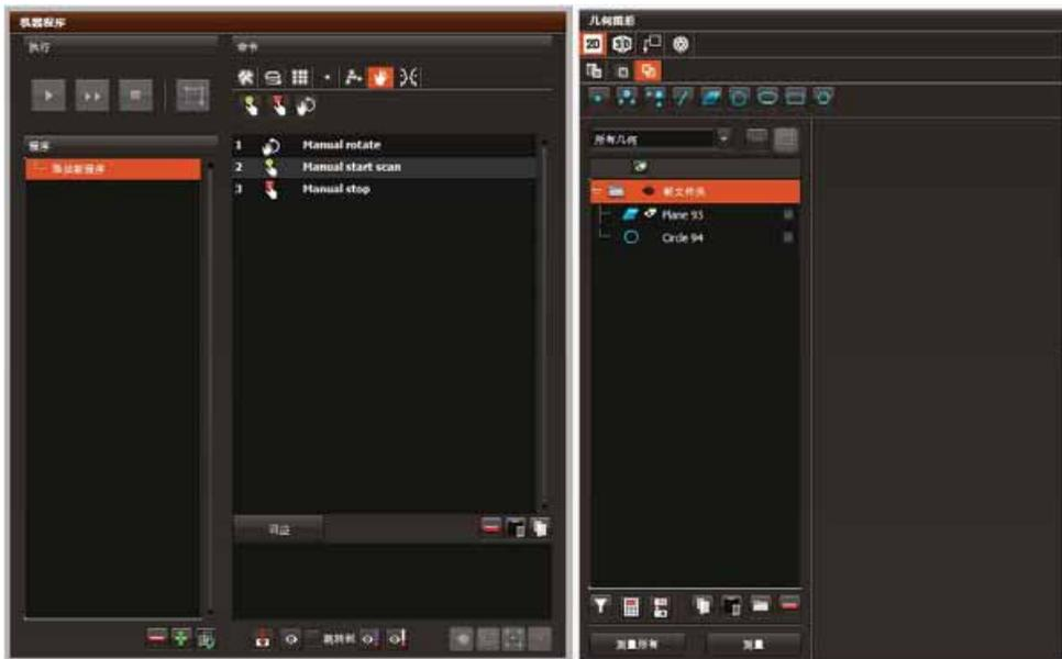
当用户运行该程序，M3 将显示一个窗口用于手动模式的接触点。
