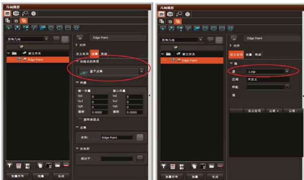
选择“获得 CAD 标称”获得点的标称值。单击您的 CAD 的边缘。M3 将显示一个窗口，在此用户必须选择正确的候选项。
