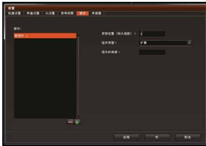
每个传感器将具有不同的机架的位置。用户必须以指出传感器窗口的那些组件。单击“传感器”，M3 将显示一个工具，其中用户必须从左列中选择将要使用的组件，并以下一个自上而下的顺序的组件去定义传感器，自头部到表面进行测量，从连接到头部的组件开始。
