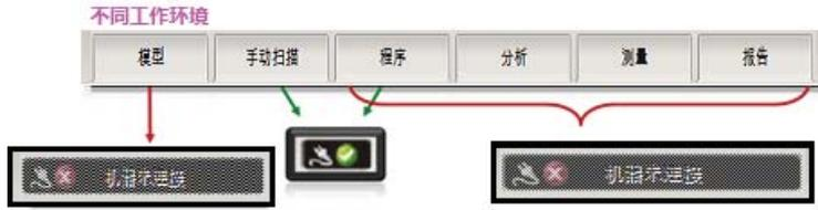
**M3** 包含不同的工作环境，用以组织一个顺序工作流。用户可以在相关机器上工作而不用连接整个工作环境，但必须联机以捕获测量信息。
