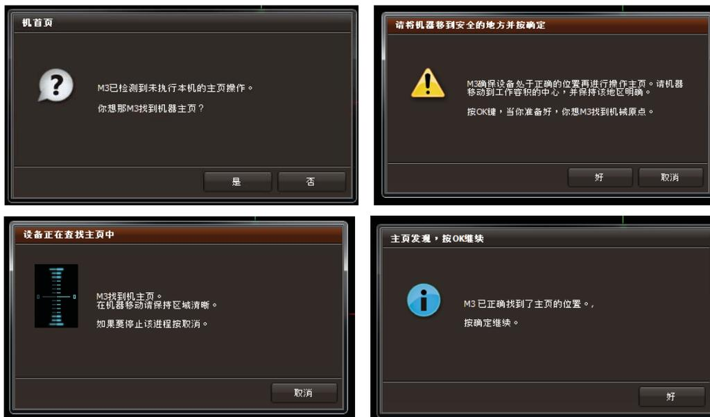
当 M3 已启动，如果机器的连接失败时，将显示下列信息。点击“是”建立连接，或点击“否”来检查问题。
