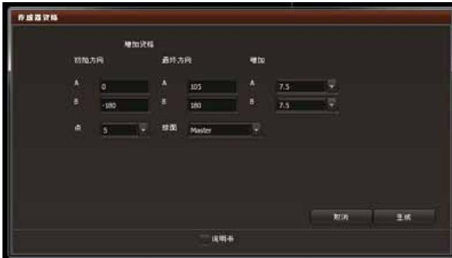
在此选项中，用户有选择初始和最终角度，设为角度 A，和角度 B。选择将被用于校准位置的点数，并选择被校准球体。
