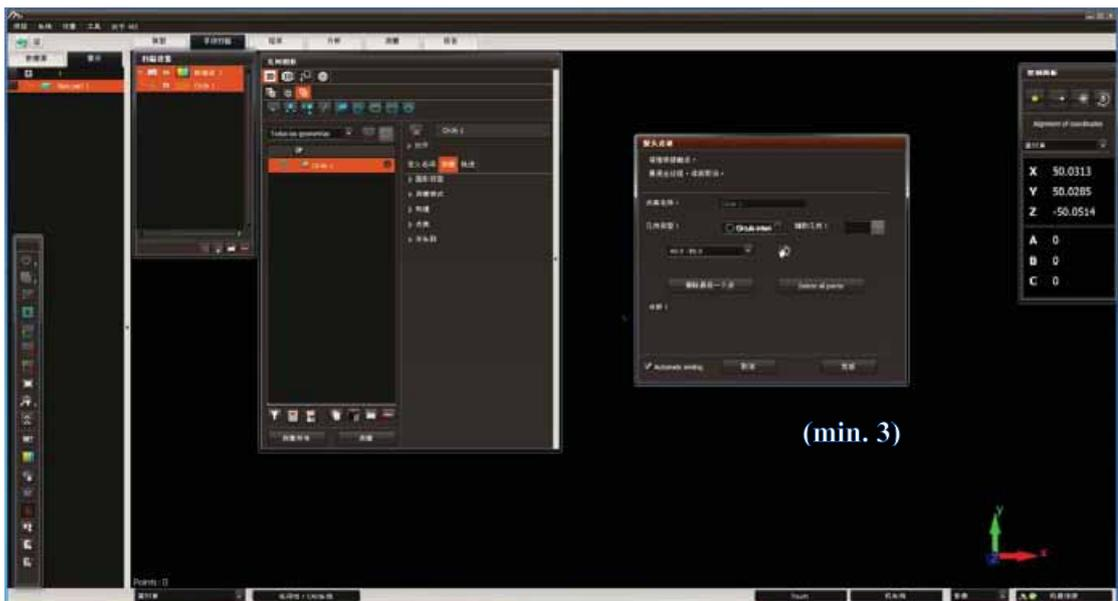
请记住，在开始捕捉处理前必须先选择部件。当用户在手动模式下工作，必须先配置主菜单（*设置/扫描设置*）中的扫描设置。根据几何形状改变补偿距离及其速度是非常重要的。
