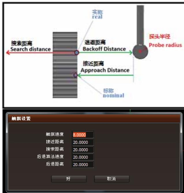
此对话框提供对所获得信息的调整，例如：触摸和后退补偿的速度，扫描方式和后退距离，以及搜索距离。
