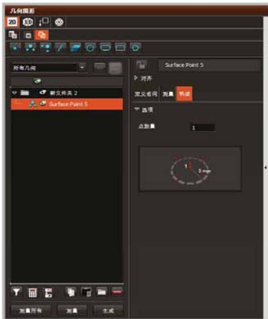
选择“获得 CAD 标称”图标（左图），以获得该点的标称值。单击您 CAD 的表面。M3 将显示一个窗口，用户将在（右图）此选择正确的名义。
