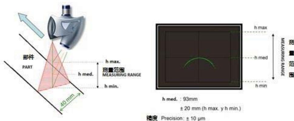
该传感器可以捕获部件上长达 40 mm 的线，当所述传感器距离 93 毫米±20 毫米。在该捕获区域中，一个点的位置精度为 10 微米。
