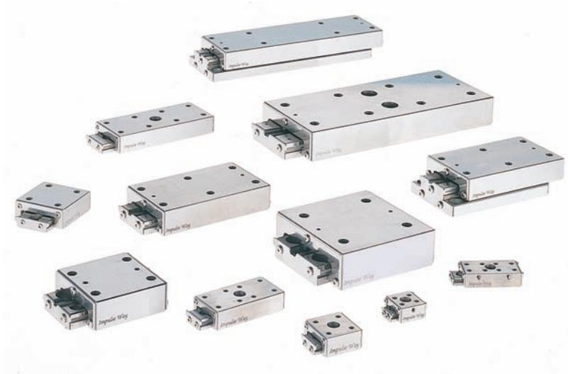
● 我们提供系列的不附带驱动机构的OEM直线滑块。这类能自由运动的直线滑块，既可以单独使用，也可以和其它机械式驱动装置或气动驱动装置一起使用。此类滑块采用了专利技术精密制造，提高了承载能力和运动直线性。不锈钢结构保证了高的热稳定性，优异的定位精度。它适用于超净工作区和真空环境。
